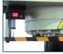
Dijital Kurs Göstergesi Digital Stroke Read out
