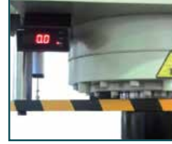
Dijital Kurs Göstergesi Digital Stroke Read out
