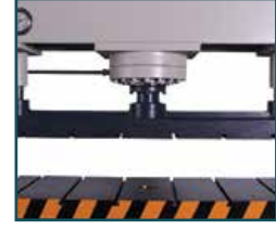
İsteğe Göre Özel T-Kanallı Tablalar Specific T-Slot Tables
