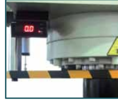
Dijital Kurs Göstergesi Digital Stroke Read out
