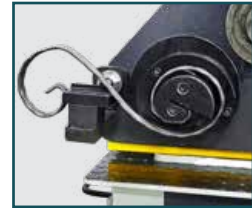
Özel Salyangoz Bükme Aparatı C&S forming attachment
