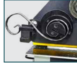
Özel Salyangoz Bükme Aparatı C&S forming attachment
