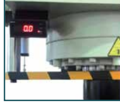
Dijital Kurs Göstergesi Digital Stroke Read out
